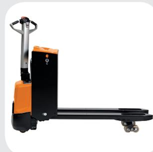
2. Самый высокий подъем на рынке – 220мм – удобен при работе на rampах и в погрузочных доках, и делает эти перевозчики идеальным инструментом для горизонтального перемещения грузов и загрузки автотранспорта. Прочная надежная конструкция вилочной каретки гарантирует плавную работу даже с самыми тяжелыми грузами.
