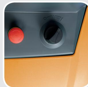
1. Оператор может выбрать максимальную скорость движения, эффективность ускорения и торможения в соответствии с выполняемой задачей и собственными предпочтениями из двух предустановленных режимов. Режим Soft делает работу с перевозчиком легкой даже для начинающих операторов и экономит энергию.
